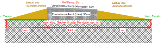
Normalprofil 1:20 (entlang See, geschottert) aufschottern im Bereich von Feldbäumen (Buchen, Eschen, Eichen, ....)
